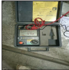
วัดค่าเมกเกอร์หม้อแปลงไฟฟ้าด้านแรงสูง - กราวด์ ได้ 47.3 GΩ
