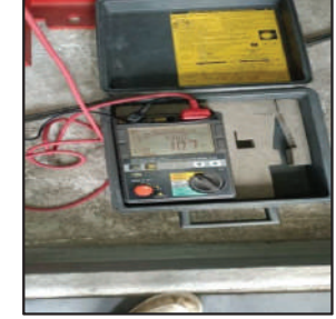
วัดค่าเมกเกอร์หม้อแปลงไฟฟ้าด้านแรงสูง - แรงต่ำ ได้ 107 GΩ
