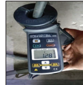
วัดค่ากราวด์หม้อแปลงไฟฟ้า TR.1 - ตู้ MDB.1 (อาคาร A) ได้ 1.28Ω
