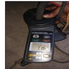
วัดค่ากราวด์หม้อแปลงไฟฟ้า TR.2 - ตู้ MDB.2 (อาคาร A) ได้ 1.16Ω
