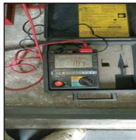
วัดค่าเมกเกอร์หม้อแปลงไฟฟ้าด้านแรงสูง - กราวด์ ได้ 107 GΩ
