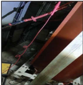
วัดค่าเมกเกอร์หม้อแปลงไฟฟ้าด้านแรงสูง - กราวด์ ได้ 47.3 GΩ
