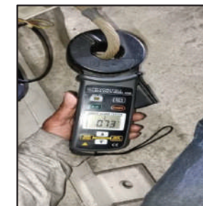
วัดค่ากราวด์หม้อแปลงไฟฟ้า TR.1 - ตู้ MDB.1 (อาคาร B) ได้ 0.73Ω
