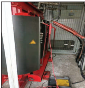
วัดค่าเมกเกอร์หม้อแปลงไฟฟ้าด้านแรงสูง - กราวด์ ได้ 107 GΩ
